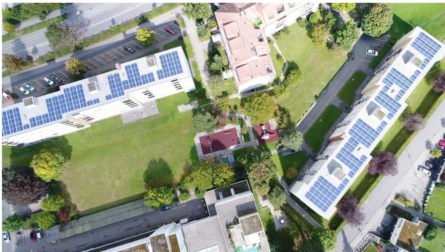
Sur les toits d'une coopérative d'habitation, ESB Energie Service Biel/Bienne a construit deux installations photovoltaïques générant au total près de 1007 MWh d'électricité par an. L'énergie solaire doit couvrir l'électricité des parties communes (pompes à chaleur, ascenseur, lave-linge, etc.). L'objectif est une part de consommation propre de près de 70 %.
